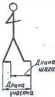
Рисунок 1. Схема к определению длины шага и линейной плотности.
