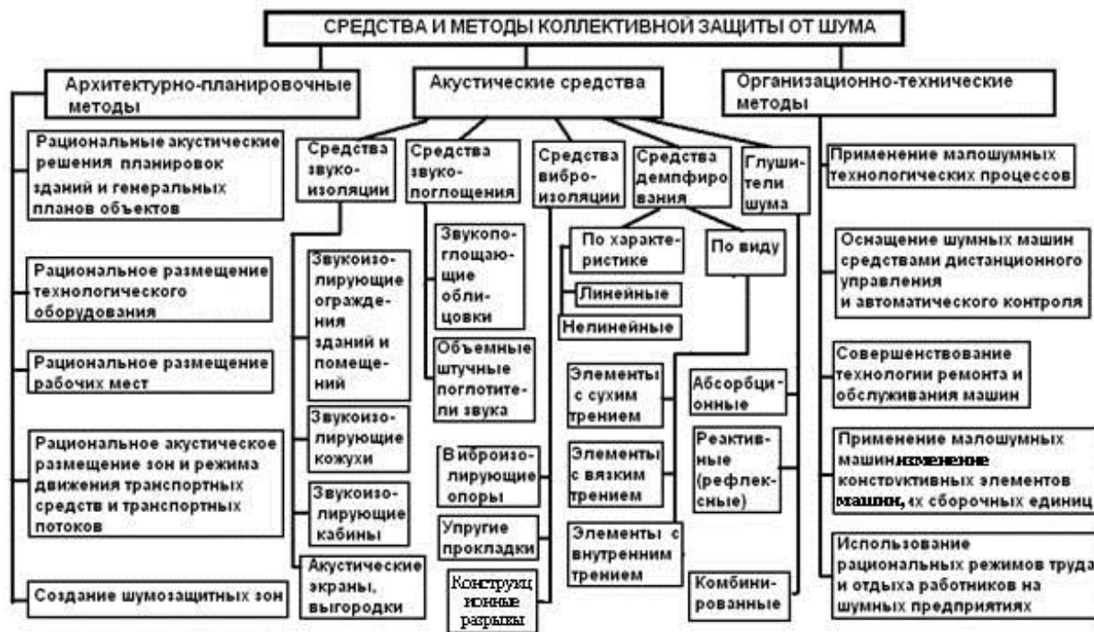
Рисунок 1. Средства коллективной защиты от шума на пути его распространения.
