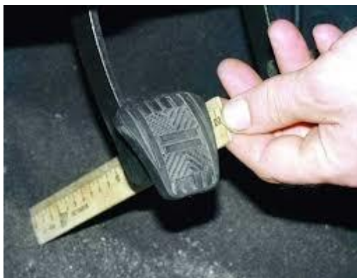
Рисунок 1– Проверка свободного хода педали сцепления.
