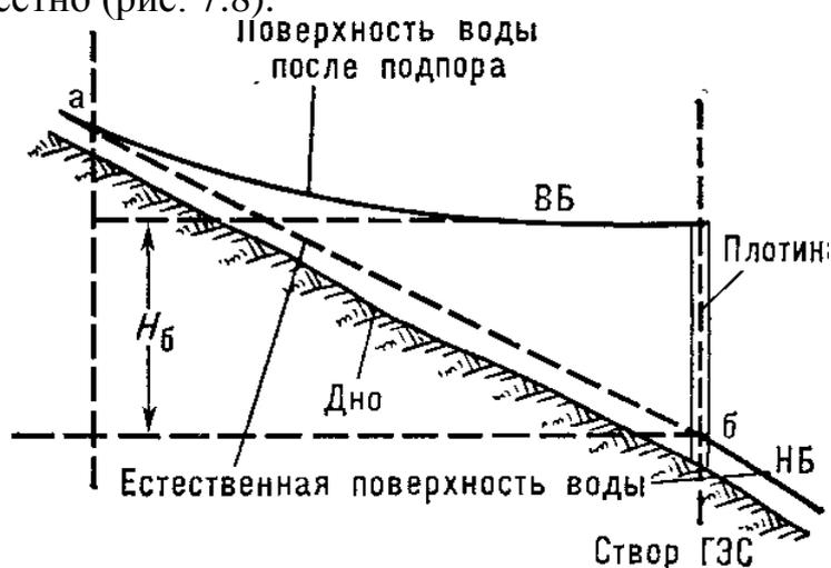
Рисунок 7.6 Схема концентрации потока плотиной
