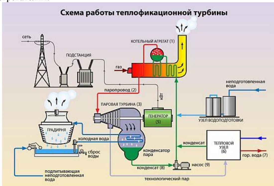
Рисунок 4.2– Схема работы теплофикационной турбины:
