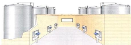
Схема 1.1 Схема размещения танков башенного типа с технологическими люками в проемах стен крытого пункта управления.
