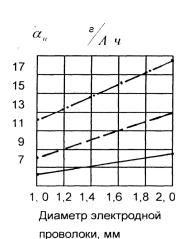
— Для вибродуговой паплавки — Для наплавки под слоем флюса — Для наплавки в среде  $CO_2$
