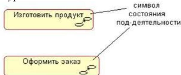
Рисунок 69 – Графическое обозначение состояния поддеятельности
