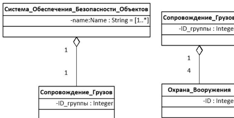
Рисунок 31 – Пример обозначения кратности отношения агрегации
