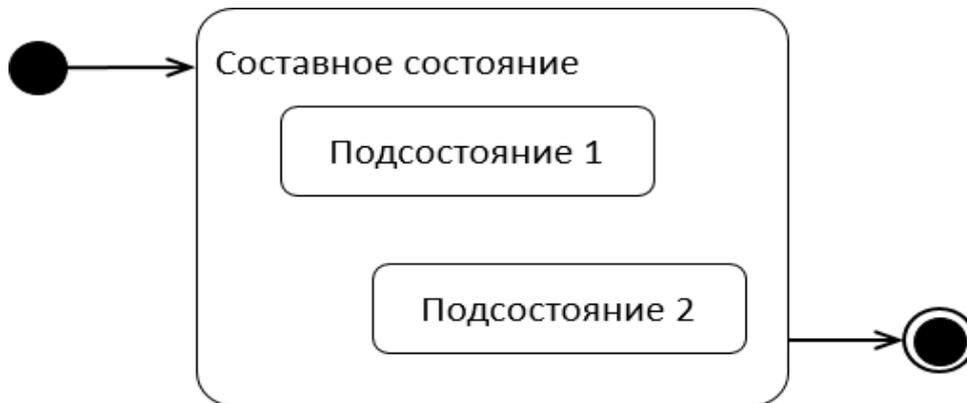
Рисунок 56 – Графическое изображение составного состояния
