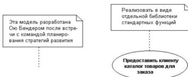
Рисунок 6 – Пример обозначения примечания
