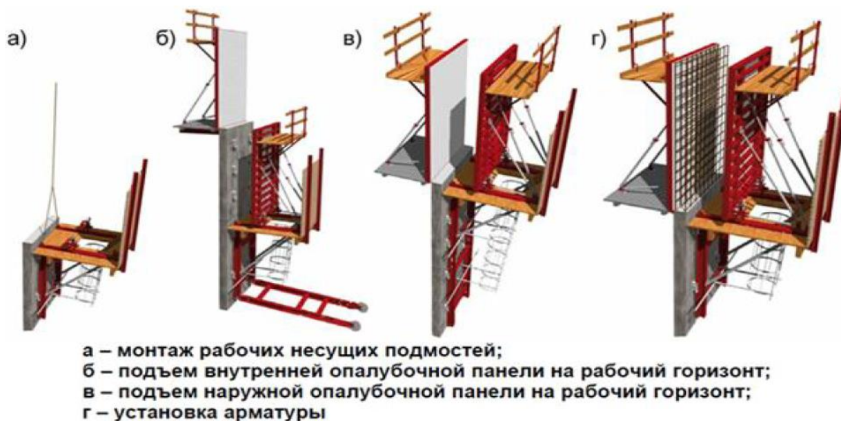
Рисунок 3.7 – Схема монтажа переставной опалубки
