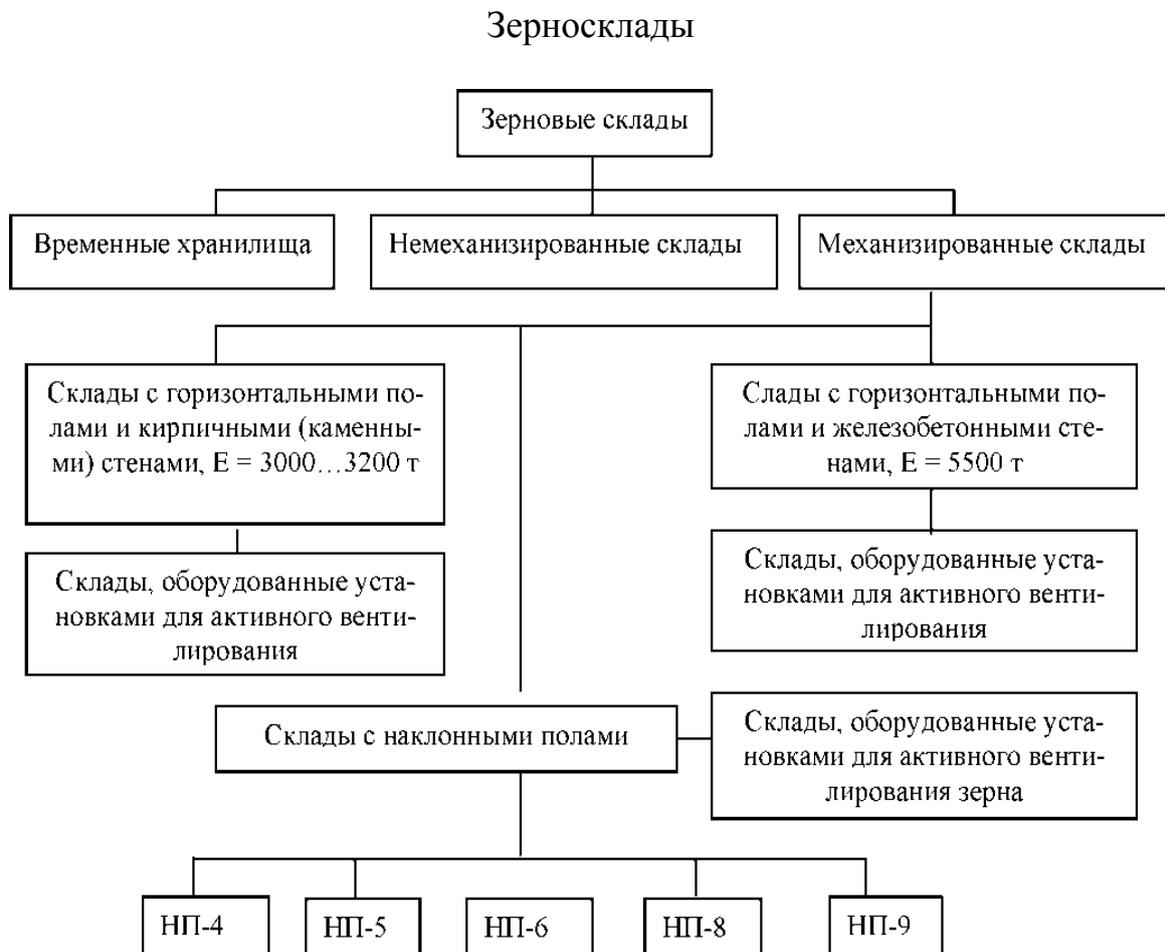
Рисунок 5 – Классификация зерновых складов
