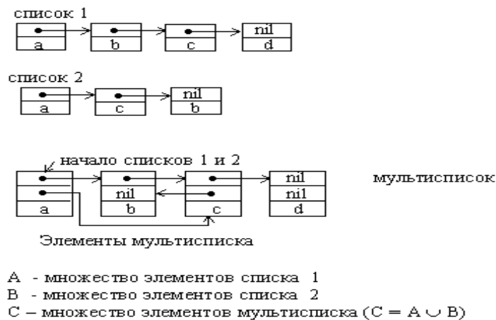
Рисунок 1.5 – Объединение двух линейных списков в один мультисписок
