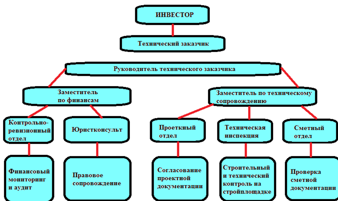
Рисунок 3.4 – Организация строительного контроля структуре технического заказчика
