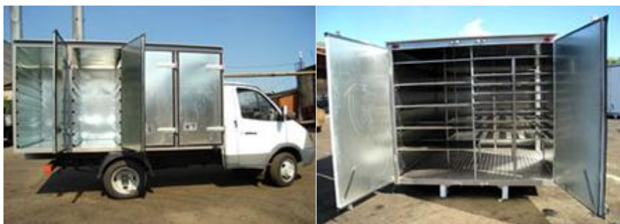
Рисунок 4– Спецавтотранспорт для транспортировки опасных отходов в одноразовой таре.
