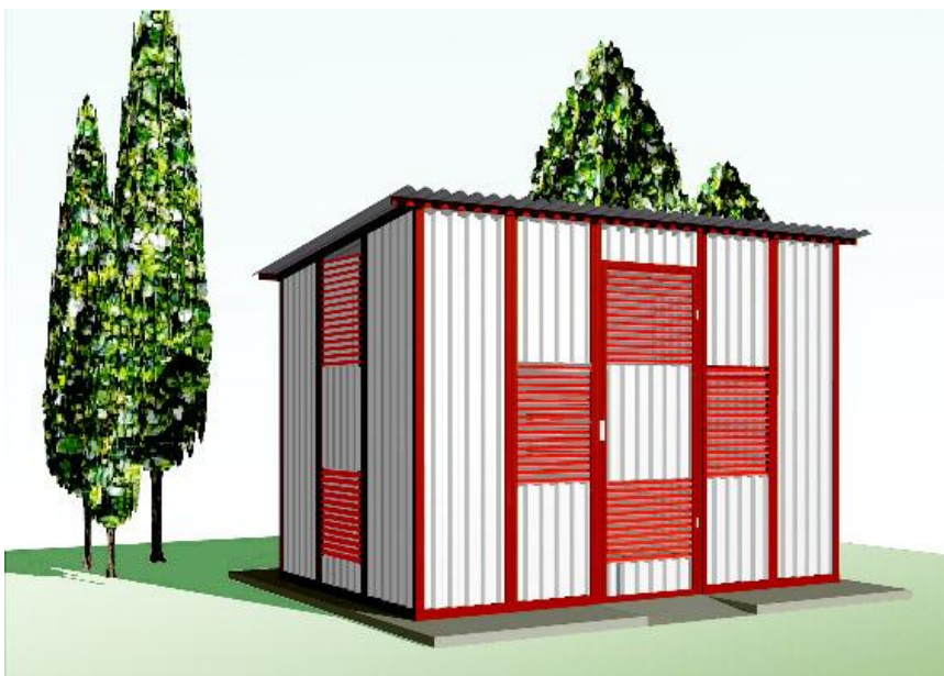
Рисунок 6– Общий вид закрытой контейнерной площадки
