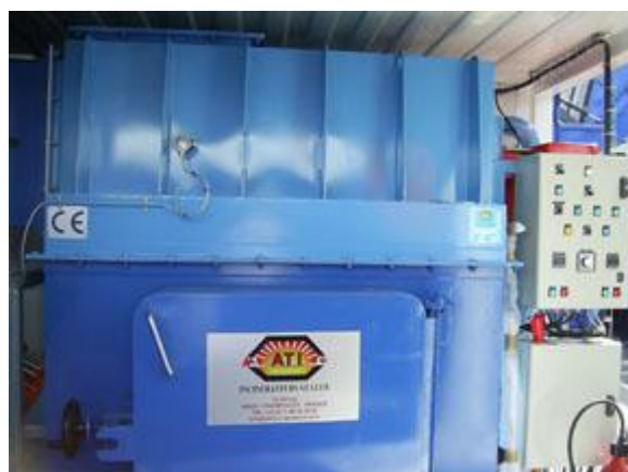
Рисунок 2– Установка «Мюллер» С.Р. 50 (50 кг/час), смонтированная в 20-футовом контейнере
