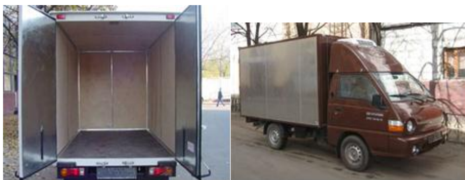
Рисунок 5– Спецавтотранспорт для транспортировки опасных отходов в оборотной многоразовой таре
