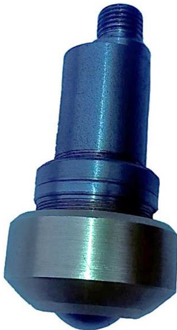
Рис.3. Разработанный инструмент для комбинированной накатки
