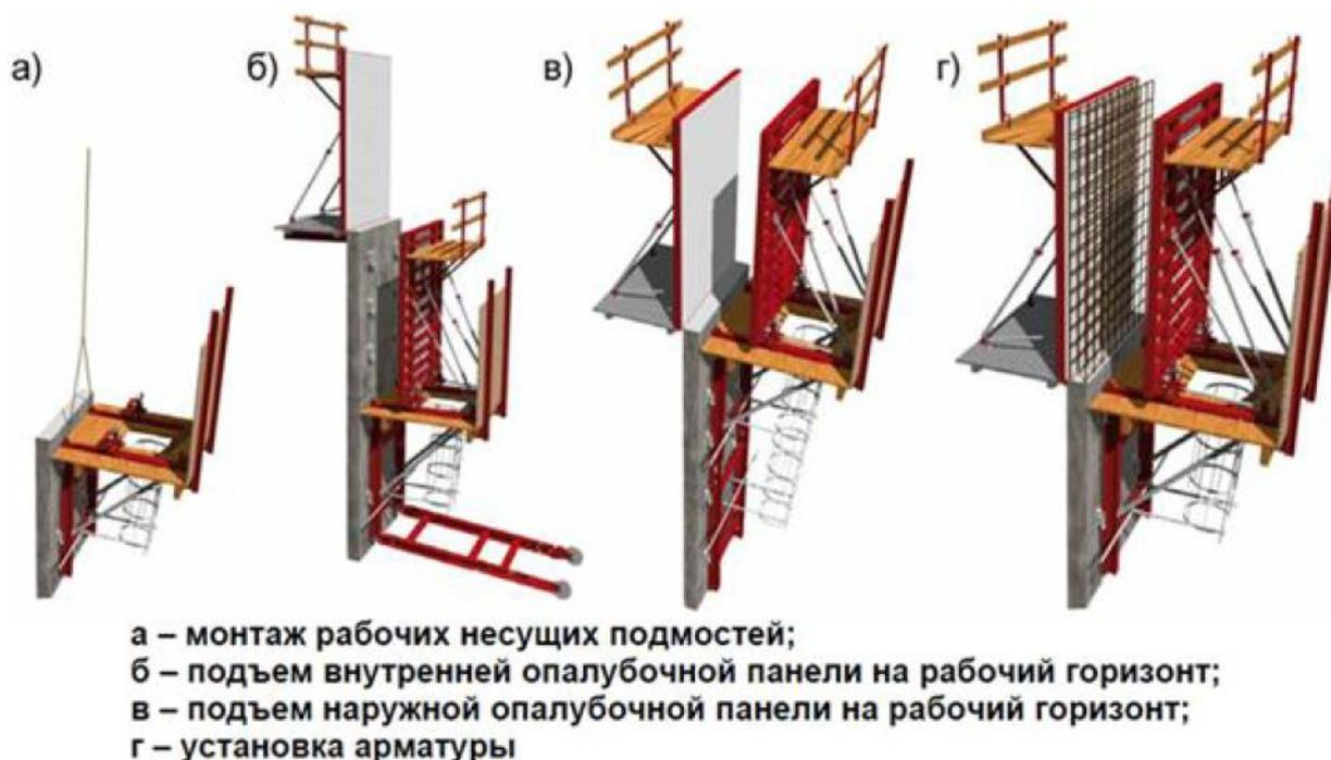
Рисунок 3.7 – Схема монтажа переставной опалубки
