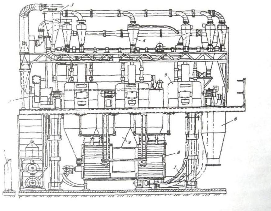
Рис. 2 – Агрегатная вальцовальная мельница АВМ-3М
