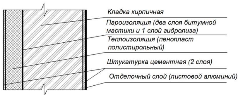
Рис. 1. Конструкция наружной стены
