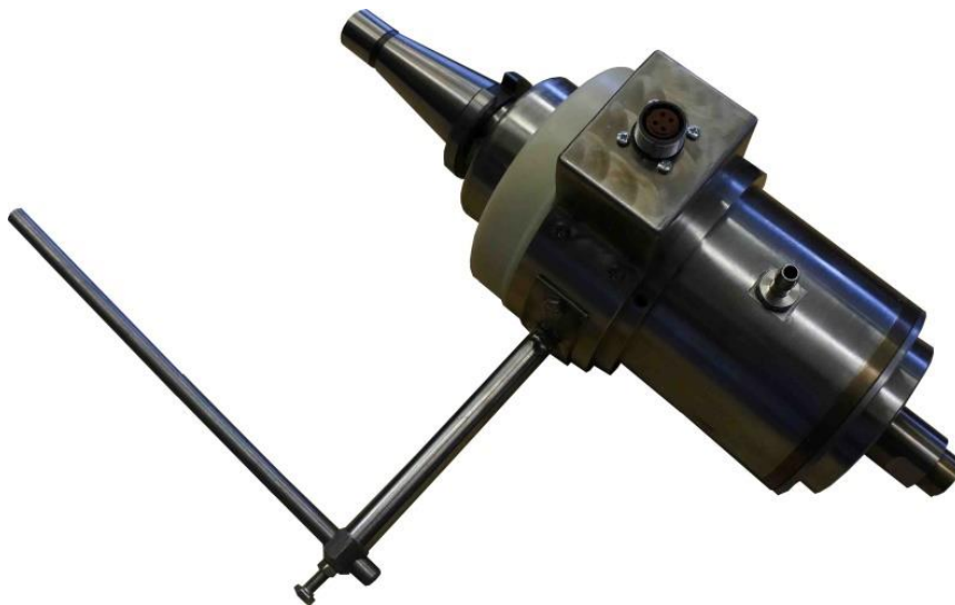
Рисунок 1. Ультразвуковая установка для финишной обработки плоских поверхностей ИЛ-4/3
