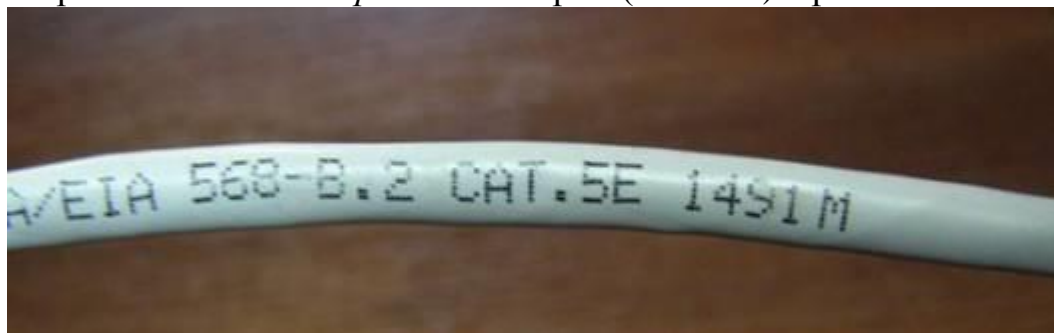
Рисунок 4.9 - Кабель витая пара
