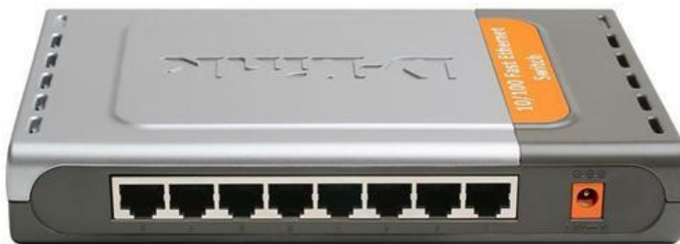
Рисунок 4.4 - Свитч D-Link DES-1008D 8-port 10/100Mbps
