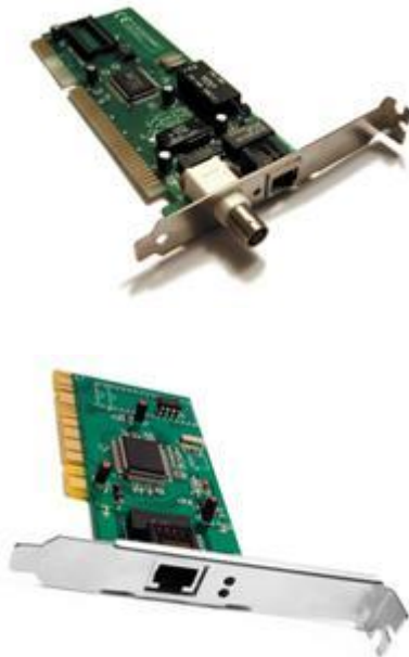
Рисунок 4.3 - Сетевые карты на коаксиал и витую пару
