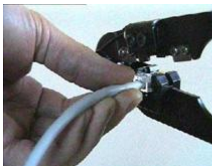
Рисунок 4.13. Коннектор вставлен в кримпер
