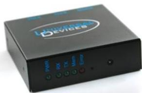
7. **Мосты (Bridge)**- устройства сети, которое соединяют два отдельных сегмента, ограниченных своей физической длиной, и передают трафик между ними (рис.11). Мосты также усиливают и конвертируют сигналы для кабеля другого типа. Это позволяет расширить максимальный размер сети, одновременно не нарушая ограничений на максимальную длину кабеля, количество подключенных устройств или количество повторителей на сетевом сегменте.
