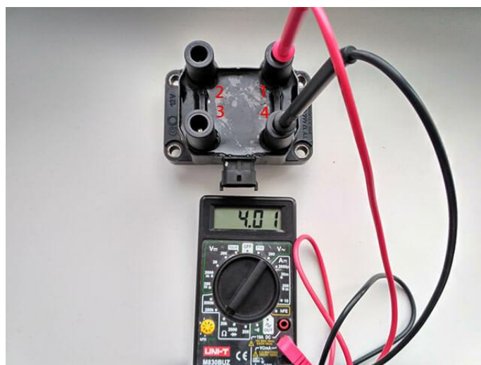
Рисунок 5.7– Проверка вторичной обмотки катушки зажигания мультиметром.
