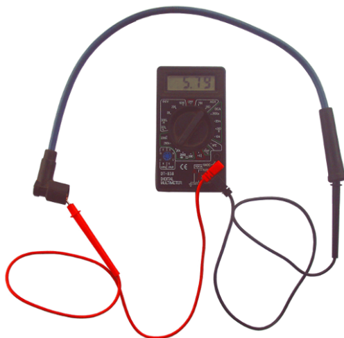
Рисунок 5.8 Проверка высоковольтных проводов мультиметром.
