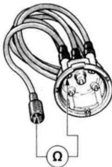
Рисунок 5.10 Проверка распределителя зажигания мультиметром.
