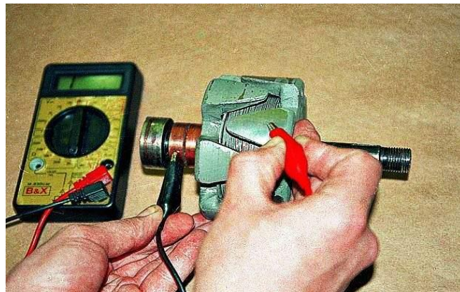
Рисунок 3.5– Проверка обмоток ротора на отсутствие замыкания на корпус
