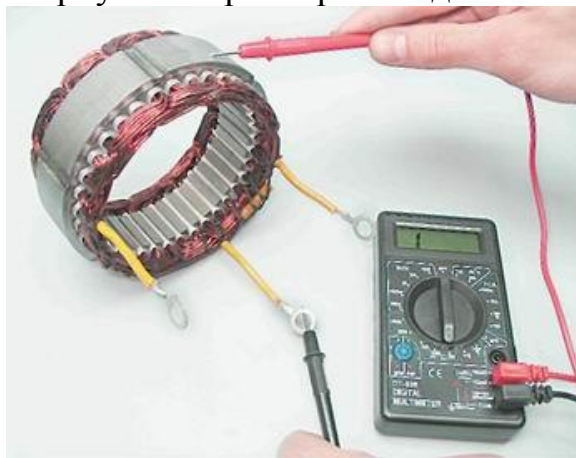
Рисунок 3.2 – Проверка обмоток статора на отсутствие замыкания на корпус
