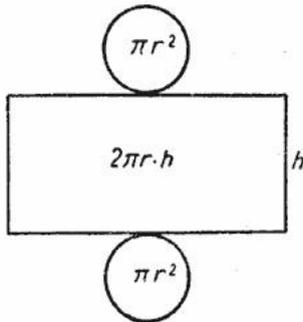
Следовательно, площадь боковой поверхности цилиндра равна площади его развёртки и вычисляется по формуле:  $S_{б.п.} = 2\pi R \cdot H$
