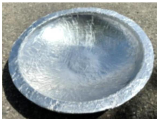
Рисунок 3. Параболический отражающий экран для фокусировки теплового излучения
