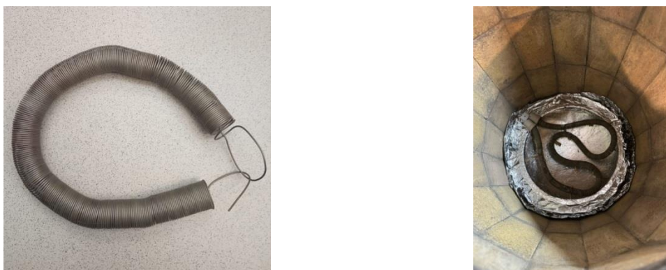
Рисунок 2. Нихромовая нагревательная спираль, установленная в нижней части печи
