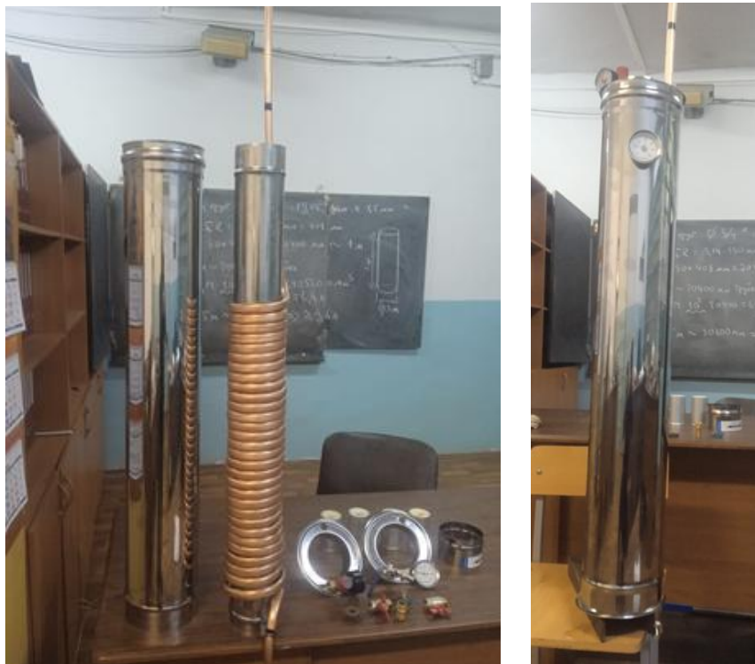
Рис. 2. Макет лабораторного образца проточного водонагревателя на дымоходной трубе.
