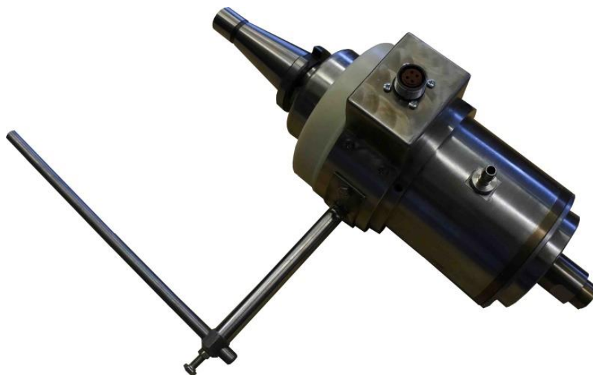
Рис.1. Ультразвуковая установка для финишной обработки плоских поверхностей ИЛ-4/3
