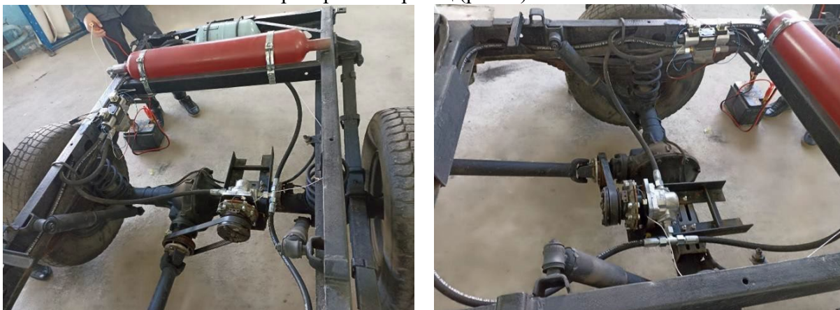
Рис. 2 Изготовленный лабораторный образец вспомогательной системы для разгона автомобиля на принципах РЭТ
