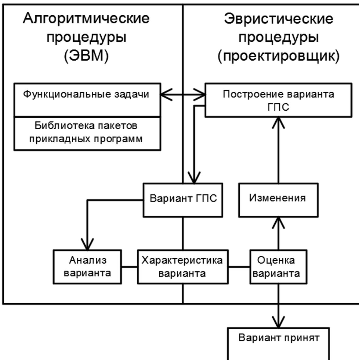
Рисунок 1. Схема процесса синтеза структуры и параметров ГПС
