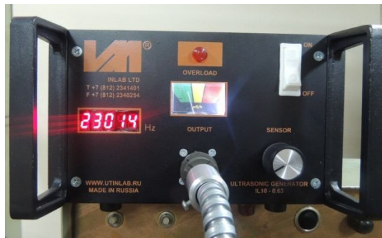
Рисунок 3 – а – ультразвуковая головка (инструмент) для обработки плоских поверхностей, б – ультразвуковой генератор ИЛ10-0,63.
