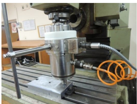
Рисунок 3 – а – ультразвуковая головка (инструмент) для обработки плоских поверхностей, б – ультразвуковой генератор ИЛ10-0,63.
