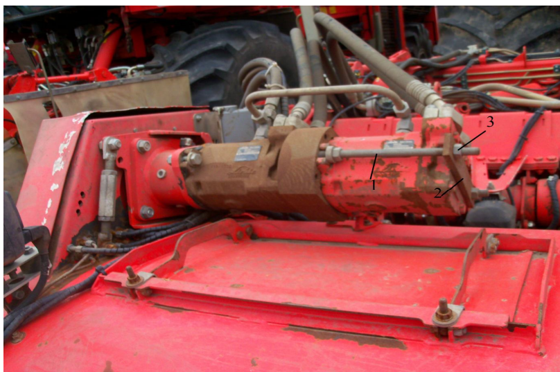
Рис. 2. Гидромотор (стабильный двигатель 1063018291): 1- шпилька, 2-планки, 3-гайка
