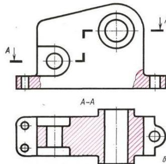
**Ломаные разрезы** — это разрезы, полученные при сечении предмета пересекающимися плоскостями. В этом случае одна секущая плоскость условно поворачивается вокруг линии пересечения секущих плоскостей до совмещения с другой секущей плоскостью, параллельной какой-либо из основных плоскостей проекций, т.е. ломаный разрез размещается на месте соответствующего вида.
