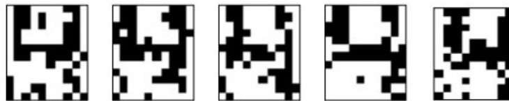
Рис. 4.5. Правильные распознавания символа «4», искаженного 20% шума «Соль и Перец», результат распознавания (слева направо): «4», «4», «4», «4», «4»
