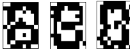
Рис. 4.6. Результаты распознавания символа «8», искаженного 10% шума «Соль и Перец», результат распознавания (слева направо): «8», «8», «6»
