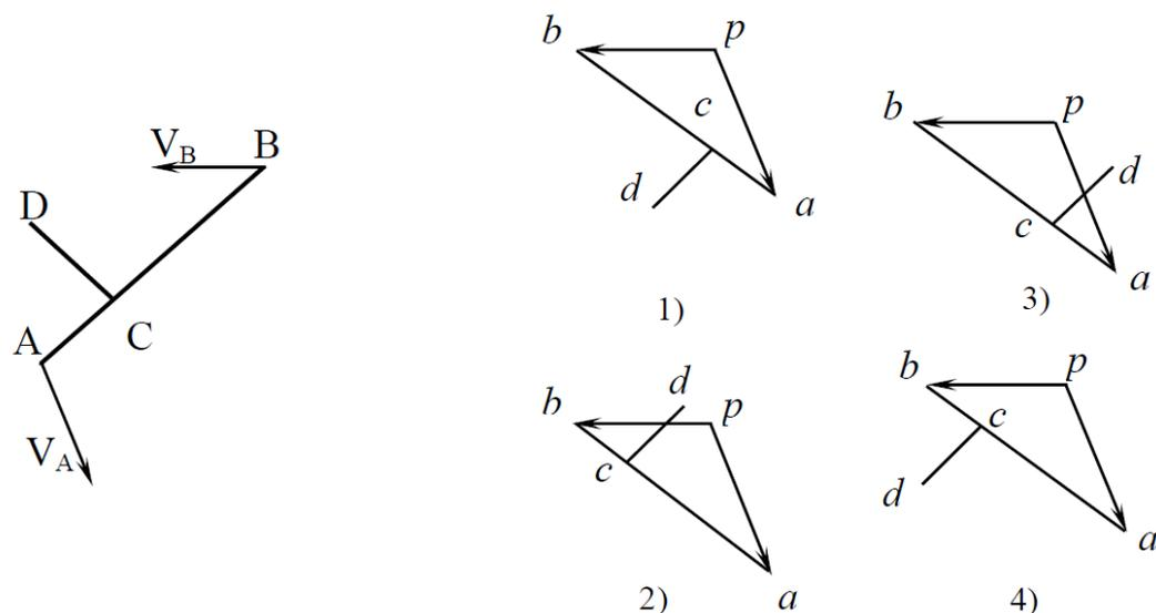
4. Правильно указывает направление ускорения Кориолиса  $\vec{a}_{C_2C_1}^k$  вектор под номером ... (ПК-13)
