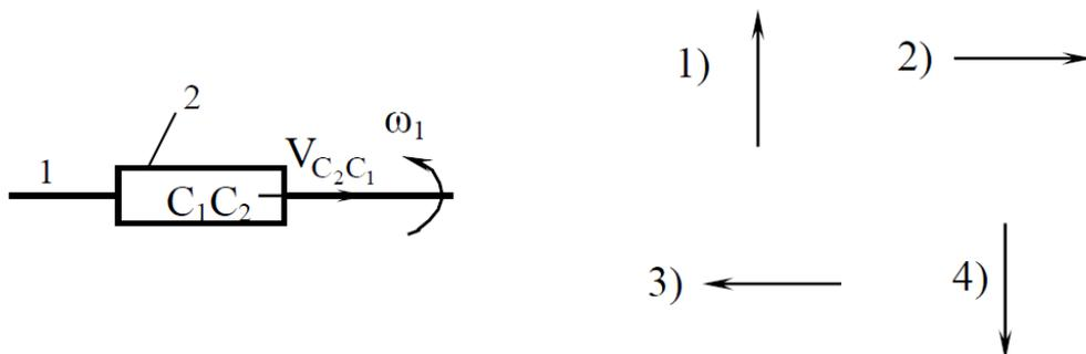
5. Правильно указывает направление ускорения Кориолиса  $\vec{a}_{C_2C_1}^k$  вектор под номером ... (ПК-13)
