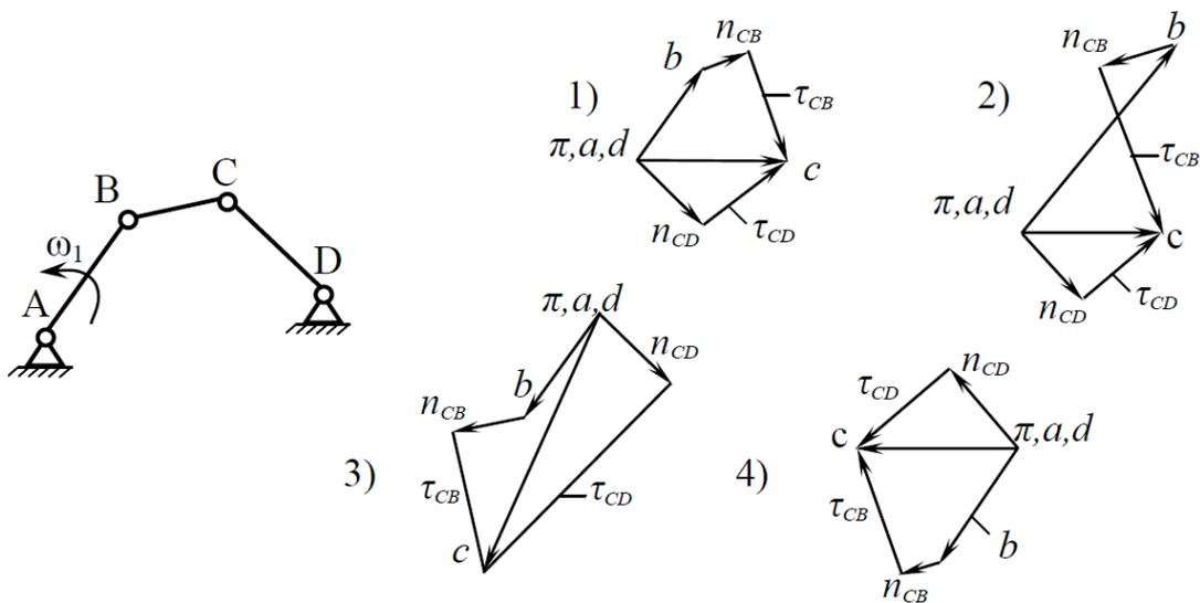
21. Принципиально верный план ускорений механизма, построенный без расчёта длин векторов, показан под номером ... (ПК-13)
