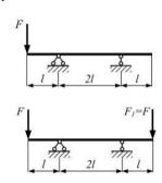
Однопролетная двухконсольная балка нагружена силой F. К балке дополнительно прикладывается сила  $F_1 = F$ . С изменением схемы нагружения прочность балки ...
