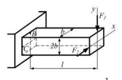
Стержень прямоугольного сечения с размерами b и 2b, длиной l нагружен внешними силами  $F_l$  и  $F_2$ . Значение нормального напряжения в точке B будет равно значению нормального напряжения в
