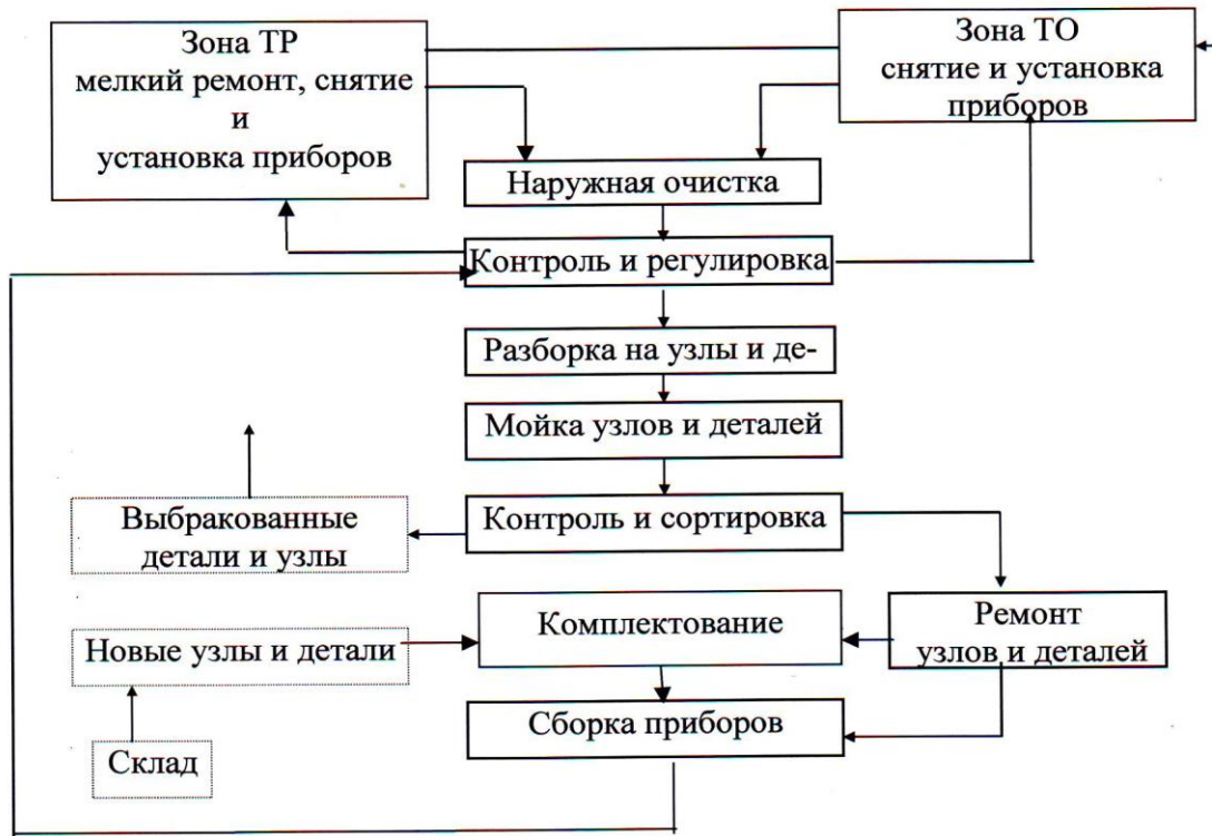
Схема технологического процесса цеха ремонта топливной аппаратуры
