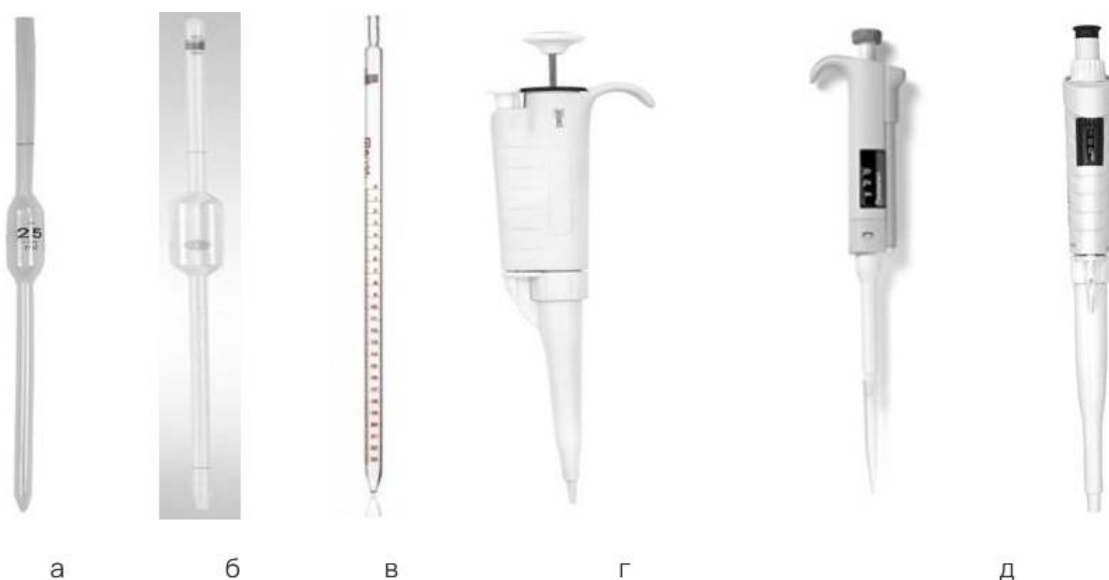
Рисунок 3 – Мерные пипетки неградуированные (а, б); градуированные (в); пипетки – дозаторы (г, д).
