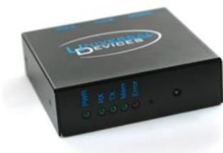
8. **Шлюзы (Gateway)** - программно-аппаратные комплексы, соединяющие разнородные сети или сетевые устройства. Шлюзы позволяют решать проблемы различия протоколов или систем адресации. Они действуют на сеансовом, представительском и прикладном уровнях модели OSI.
