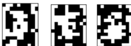
Рис. 4.2. Неверные распознавания символа «0», искаженного 20% шума «Соль и Перец», результат распознавания (слева направо): «2», «3», «5»
